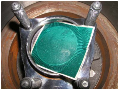
Un papier révélateur, chargé de particules métalliques, permet de visualiser les champs magnétiques générés par la cible Photo ANEX
