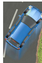
Le survirage : les roues arrière perdent leur pouvoir de guidage latéral et le véhicule a tendance à se diriger vers l'intérieur du virage.
