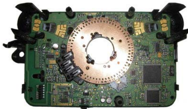
Capteur optique intégré dans le combiné de bord de l'Opel Astra Photo ANEX
