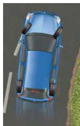
Le sous-virage : les roues avant perdent leur capacité directionnelle et le véhicule a tendance à " tirer tout droit ".
